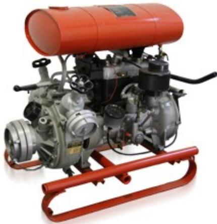
Abb 5: Tragkraftspritze TS 8
