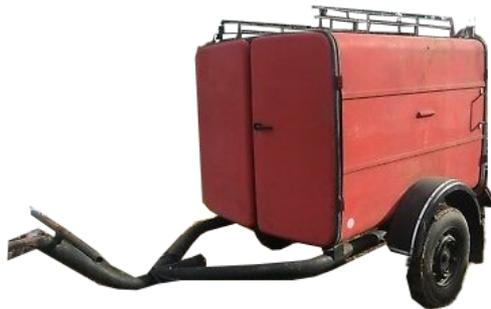
Abb 4: Tragkraftspritzen-Anhänger TSA
